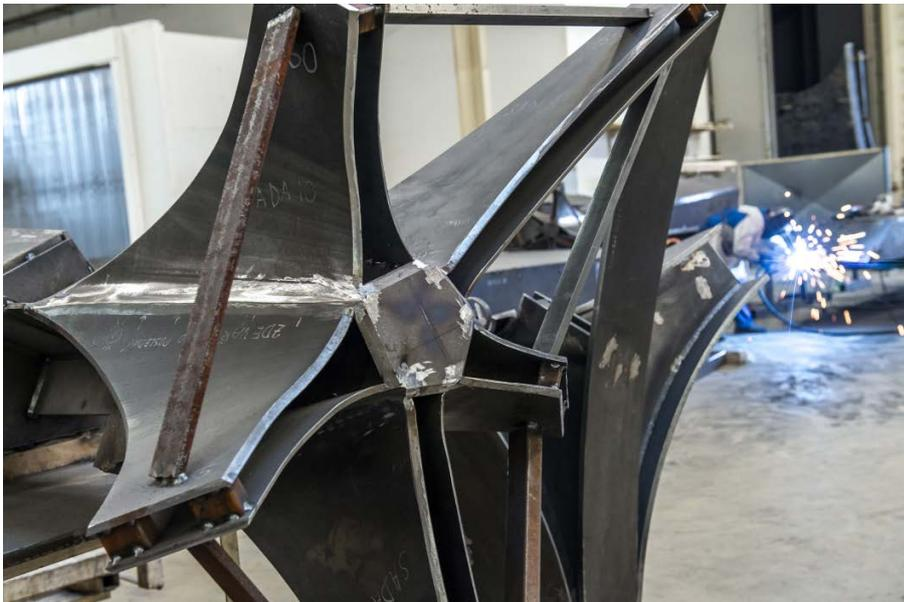
Stahlfertigung der Stahlbaumstützen für das Projekt Château Margaux am Standort seele pilsen. ©seele/René Müller
