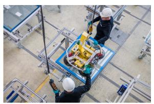
Hohes Maß an Flexibilität bei seele in Gersthofen: eigens für ein Projekt entwickelte drehbare Montagetische für den Zusammenbau. ©seele
