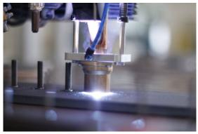
Maßgeschneiderte Bolzenschweißanlage: In der Stunde können bis zu 1.000 Bolzen aufgeschweißt werden, was die Bearbeitungszeit in der Fertigung enorm verringert. ©seele
