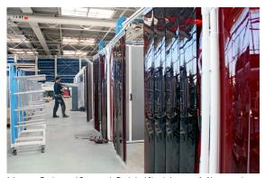
Neue Schweiß- und Schleifkabinen: Mit modernster Absaug- und Filteranlage, mehr Arbeitsplätzen und größerer Fläche sowie höhenverstellbaren Montagetischen, kann nun noch effizienter und komfortabler gearbeitet werden. ©seele
