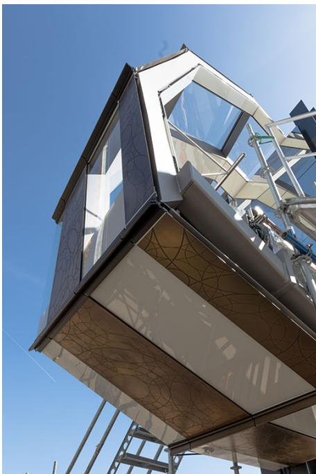
BU: Mock-up-Aufbau auf dem Testgelände der seele GmbH in Gersthofen/Deutschland in einem 3m langen Vertikalschnitt. ©seele
