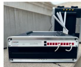
Basis der digitalen Infrastruktur auf der Baustelle bilden sogenannte **Extender Cases**, die eine stabile 5G-Netzverbindung zur Verfügung stellen. IT-Terminals, die mit Screens ausgestattet sind, zeigen in unmittelbarer Nähe der Arbeiten den aktuellen Planstand.
