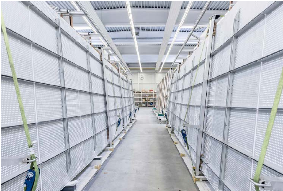
Verbundsystem aus Glas mit Silikon verklebten Aluminiumkassetten. ©seele/René Müller
