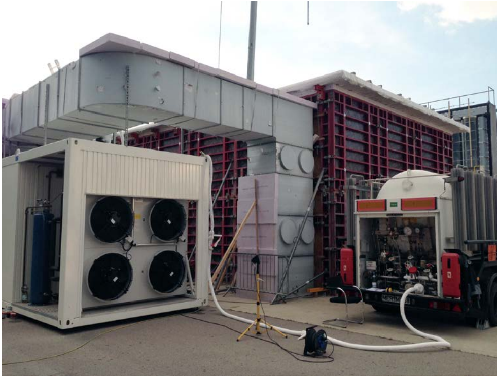
Prüfkammer mit Klimatechnik und Tankanhänger für flüssigen Stickstoff, Mock-up zum Projekt Brookfield Place ©seele
