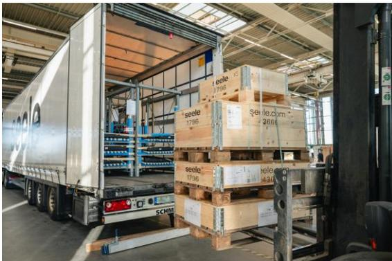
Jedes Packstück erhält an der Längsseite ein eigenes RFID-Label, damit es vom Lesegerät erfasst werden kann.
