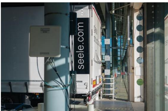
Passiert ein LKW von seele eines der Gates, wird die Ladung automatisch erfasst und die Information an das ERP-System übermittelt.
